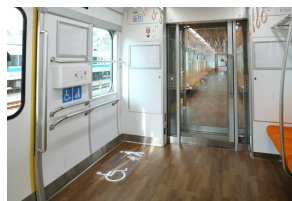
「5000形」の車いすスペース
