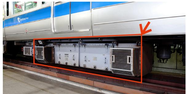
1000形リニューアル車両VVVFインバータ制御装置(赤枠部分)
