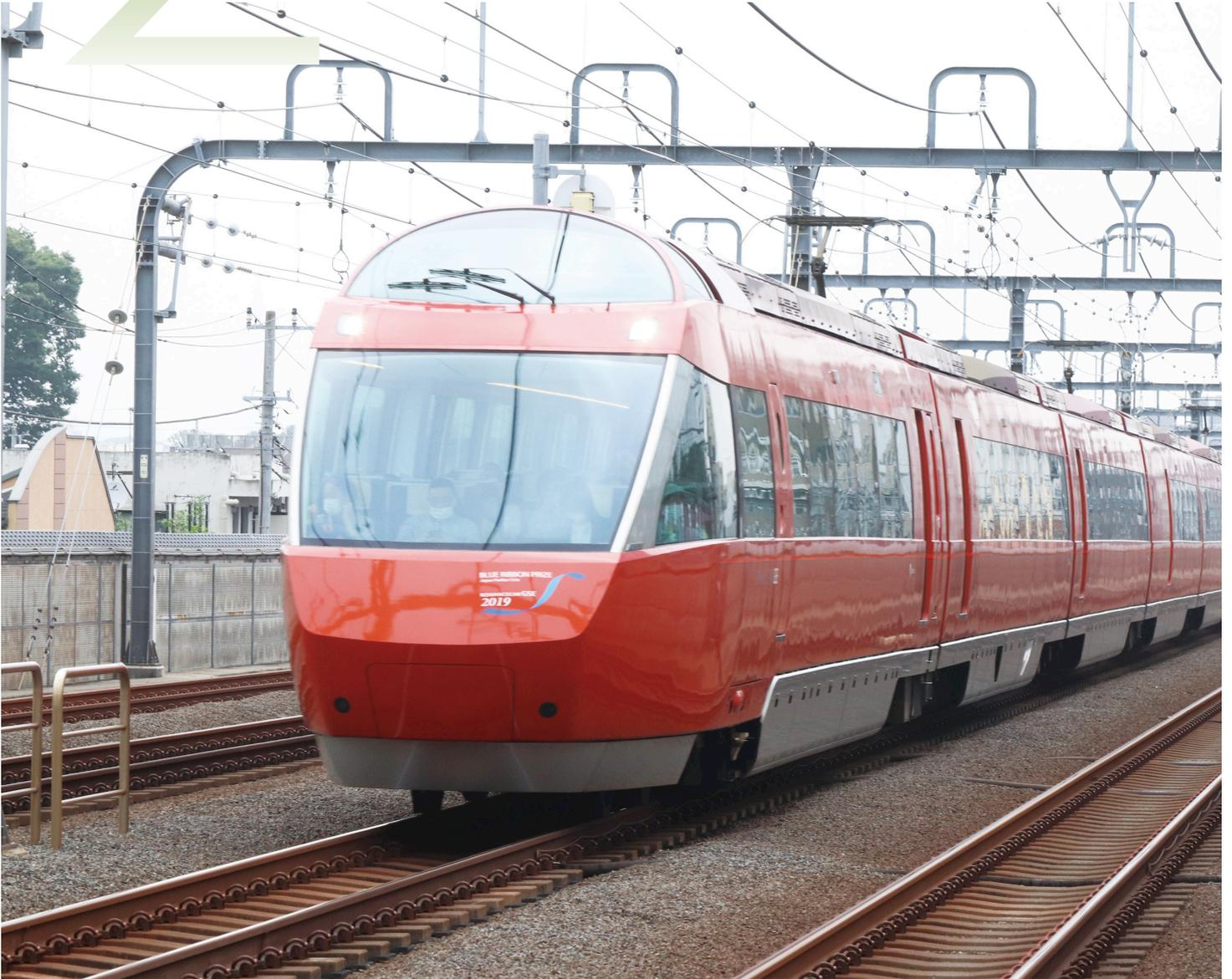
線路脇の防音壁やレールの継目を少なくするロングレール化などにより、騒音・振動を低減
