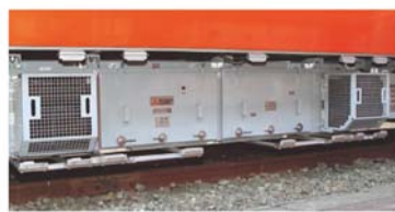
VVVFインバータ制御装置
