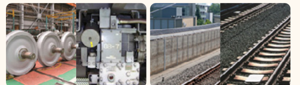
防音車輪と低騒音型コンプレッサー 防音壁と弾性枕木碎石軌道
