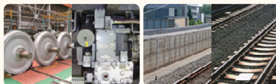
防音車輪と低騒音型コンプレッサー 防音壁と弾性枕木砕石軌道
