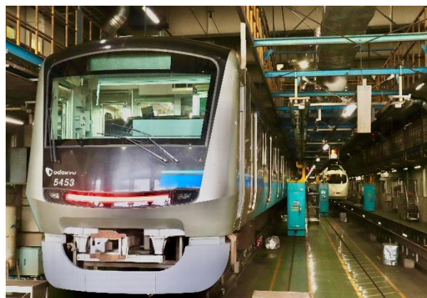
喜多見電車基地 車両検査ピット線の様子
