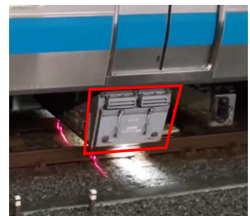
線路設備モニタリング装置
