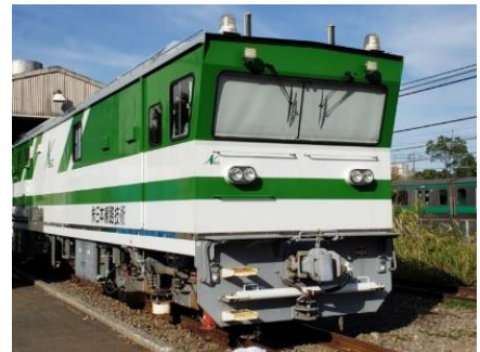
レール内の傷を検査する保守用車
