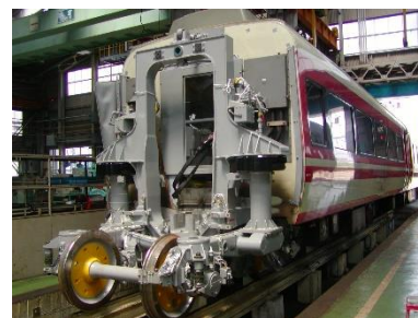
ロマンスカーを改造して 取り付けた試験台車
