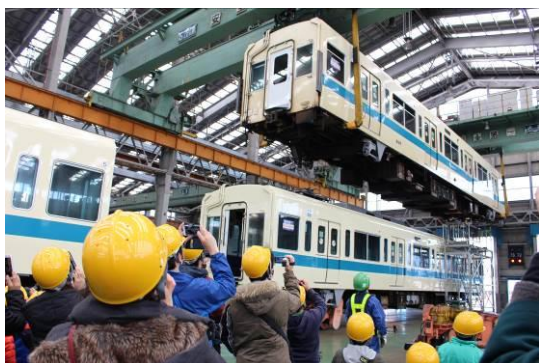
迫力ある車体上げ作業
