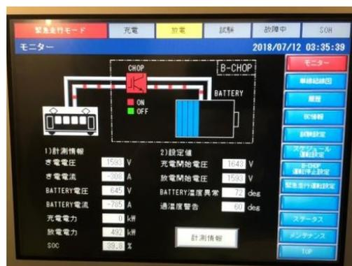
緊急走行時の回生電力貯蔵装置 制御画面
