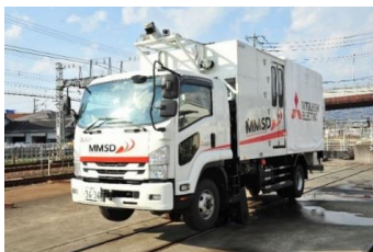
導入する軌陸車（検査車両）
