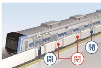
tQRのデータを判定装置側で使用することで、車種（一般車、特急車など）ごとに開閉する開口の変更が可能です。
