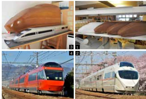
1.オフィスに並べられたクレイモデル 2.初作品となったVSE(50000形) 3.エッジや面の造形表現に使用された大型のクレイモデルと、最初にカラー提案したシルバーのVSE。駅構内で黒く見えるため、ホワイトに変更された 4.曲面ガラスを使用し、窓を大きくしたGSE(70000形)
